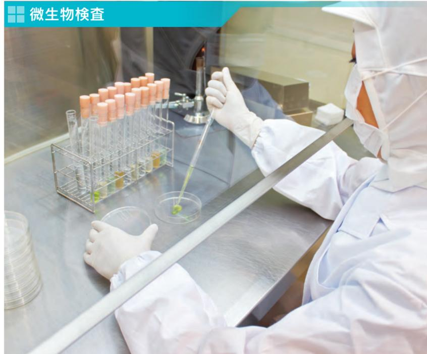
食品を製造する上で微生物試験は重要な検査のひとつです。食品腐敗や、食中毒を引き起こす要因の多くが微生物によるものです。当社は工場に検査室を併設し、製造した商品が安心・安全に提供できるよう細菌検査を実施しています。また、工場内のふき取り検査も実施し、衛生面の管理にも努めています。
